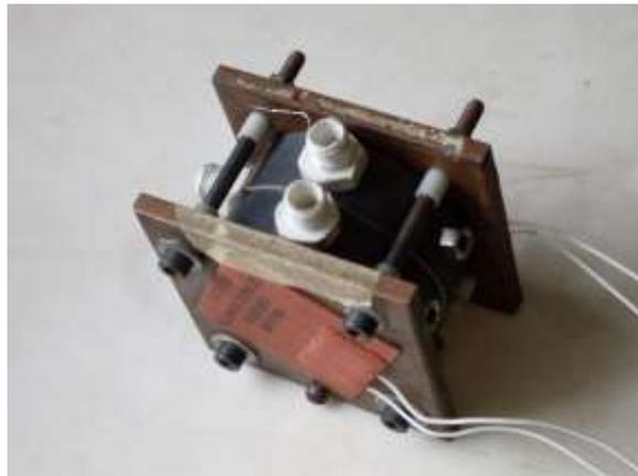
Prototipo para prueba de ensambles electrodo-membrana
