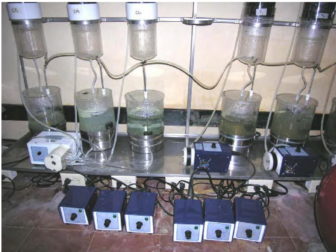
Montaje de tanques para lixiviado, bombas y controladores de temperatura, utilizados para el proceso de biodesulfurización de carbón a escala banco. (Imagen tomada de la tesis BIODÉSULFURIZACIÓN DE CARBÓN DE LA ZONA RÍO GUACHINTÉ – RÍO AZNAZÚ VALLE DEL CAUCA Y CAUCA EN BIORREACTORES DE COLUMNA UTILIZANDO MICROORGANISMOS NATIVOS del investigador Gerardo Caicedo)
