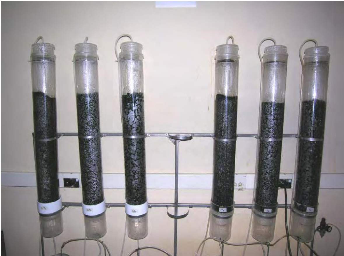
Montaje de columnas empacadas para el proceso de biodesulfurización de carbón a escala banco. (Imagen tomada de la tesis BIODÉSULFURIZACIÓN DE CARBÓN DE LA ZONA RÍO GUACHINTÉ – RÍO AZNAZÚ VALLE DEL CAUCA Y CAUCA EN BIORREACTORES DE COLUMNA UTILIZANDO MICROORGANISMOS NATIVOS del investigador Gerardo Caicedo)
