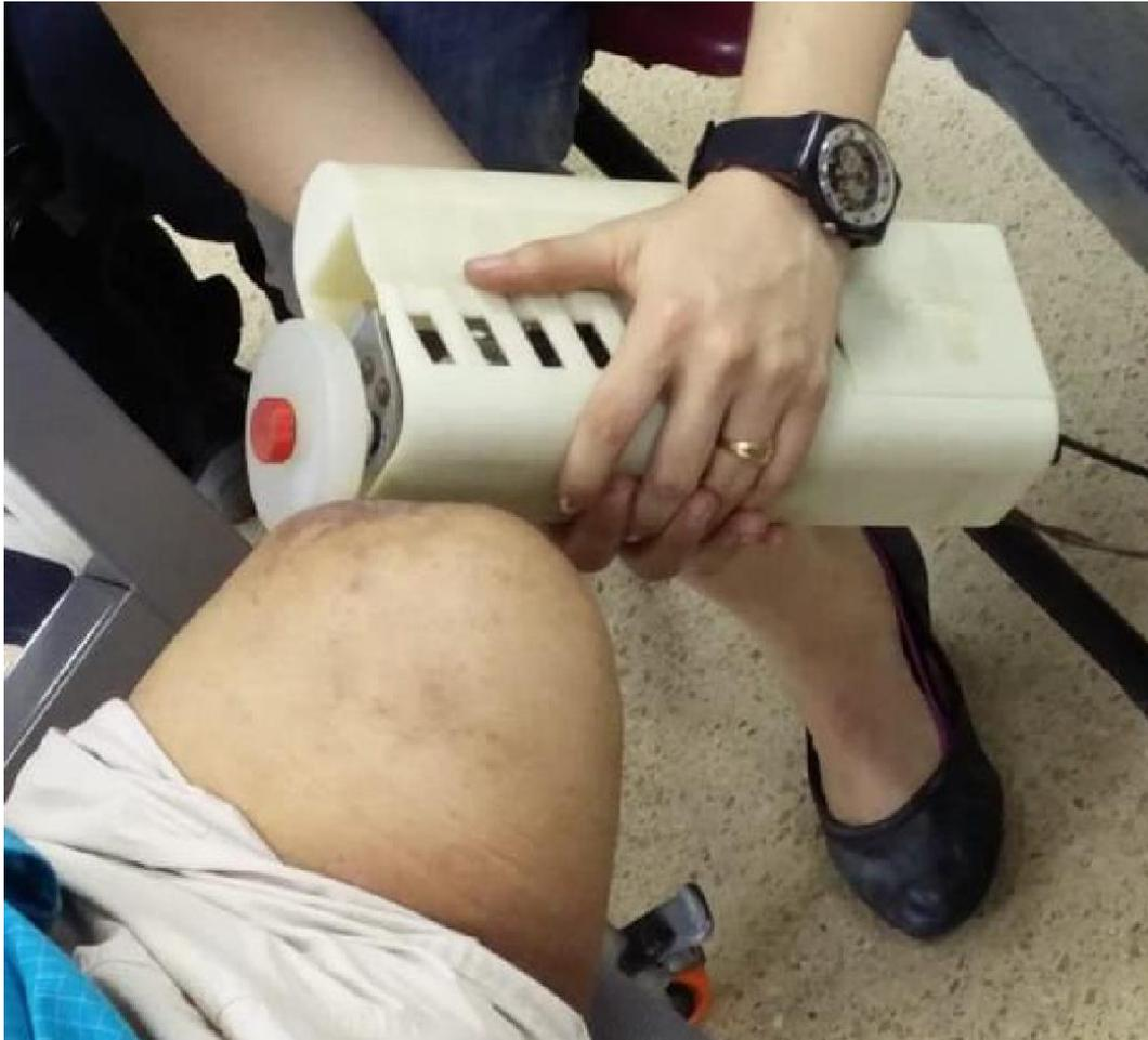
*Medición del coeficiente de fricción en miembro residual*
