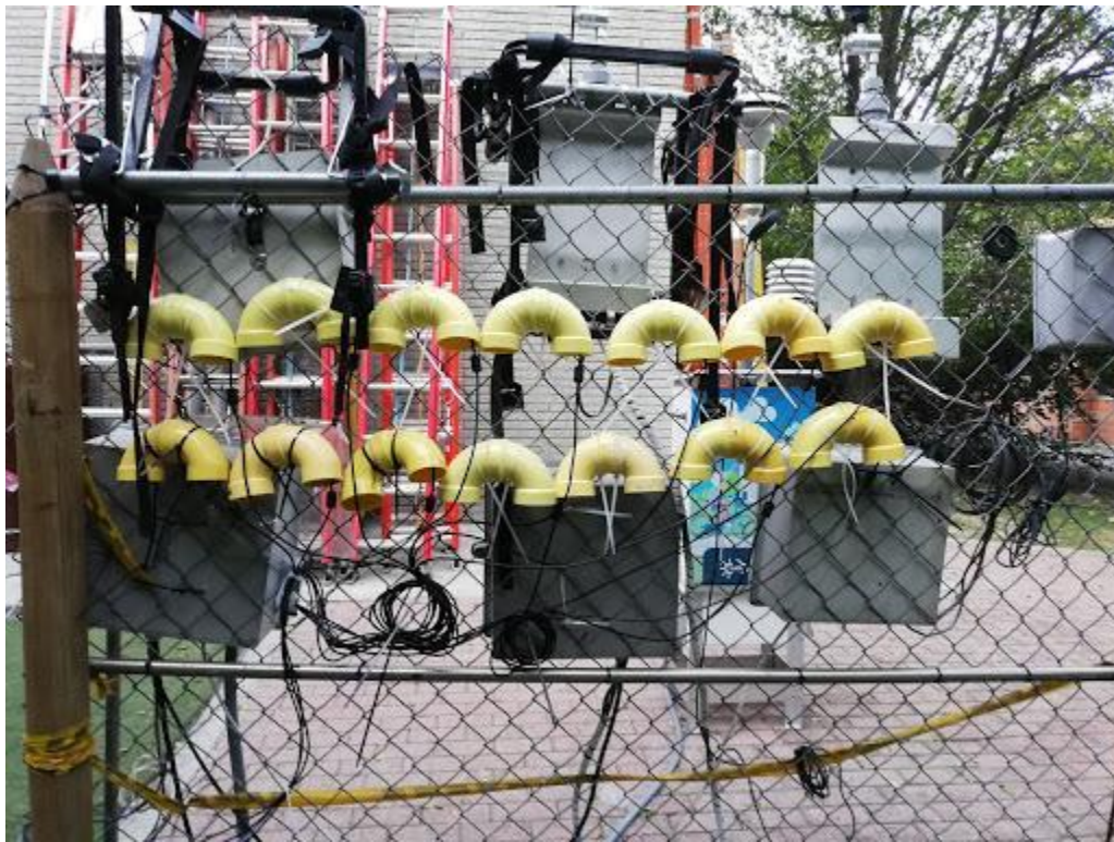
Sensores desarrollados por el grupo, ubicados con los equipos de SIATA para lograr su calibración. (Foto compartida por Jenny Ríos, investigadora del grupo)
