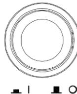
Botón de encendido: Enciende y apaga el osciloscopio.
