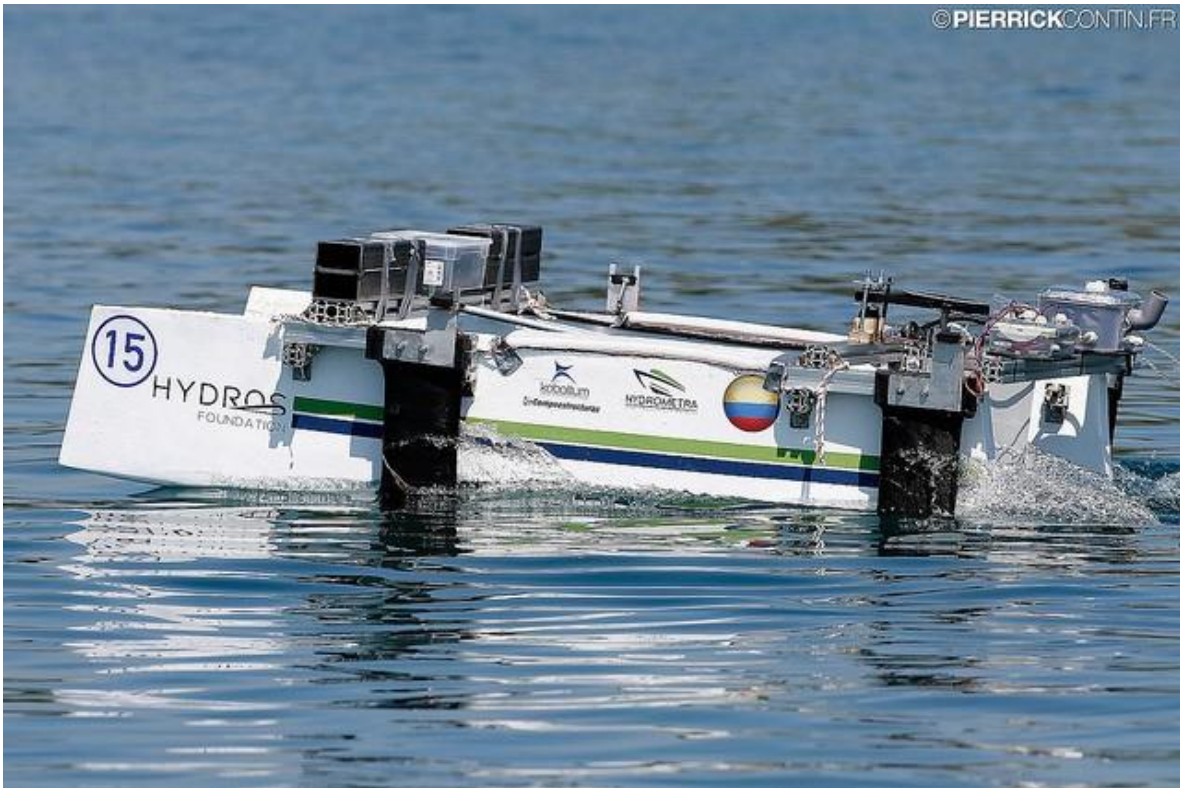
El equipo colombiano recibió un premio por el diseño más innovador, una embarcación tipo catamarán con foils que simulan las alas de un avión y flaps que permiten que el barco se sustente sobre el agua garantizando su estabilidad.
