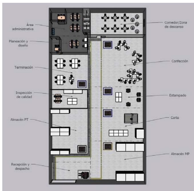
Figura 10.10. Mejor alternativa de distribución en planta para la instalación propuesta para el caso de estudio.
