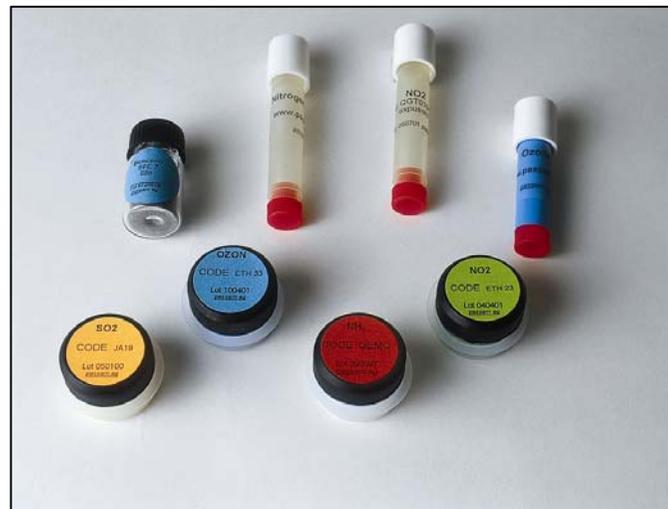
Figura 1. Tubos pasivos de difusión para gases.
