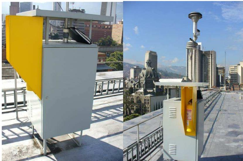
**PM<sub>10</sub> manual.** Se encuentra en buen estado físico. Periódicamente se realiza mantenimiento general, limpieza de timer y estructura física. Semanalmente se revisa buen funcionamiento del motor y las condiciones de operación del equipo para validación general de los datos. Durante el periodo abril 2011 y abril 2012 no hubo inconvenientes en su operación
