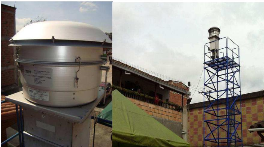
**PM<sub>10</sub> manual.** El equipo funciona correctamente. Se le ha realizado mantenimiento general al cabezote, rack, motor y timer. En el mes de diciembre se perdieron algunos datos debido a que se tuvo que desconectar el equipo para realizar las obras de aumento de plataforma.
