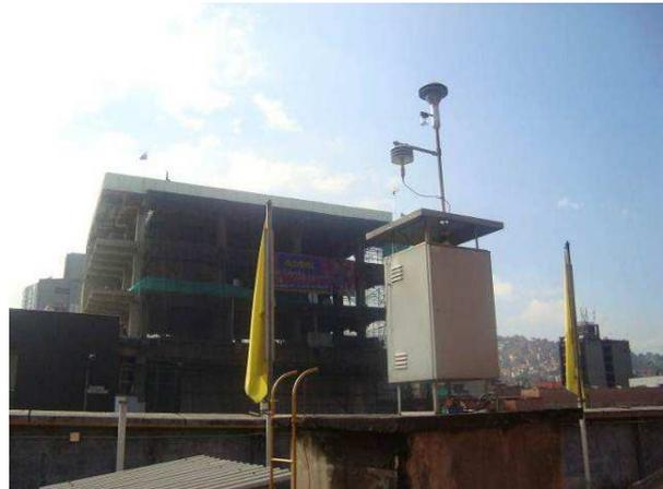
**Muestreador pasivo BTX.** Se comenzó en el mes de septiembre de 2011 y se finalizó en mayo 2012 con la toma de muestra y contramuestra para la determinación de la concentración de BTX (Benceno, Tolueno y Xileno) en la atmósfera, mediante la utilización de la técnica de monitoreo pasivo, donde cada 28 días se realiza el cambio de captadores passam.
