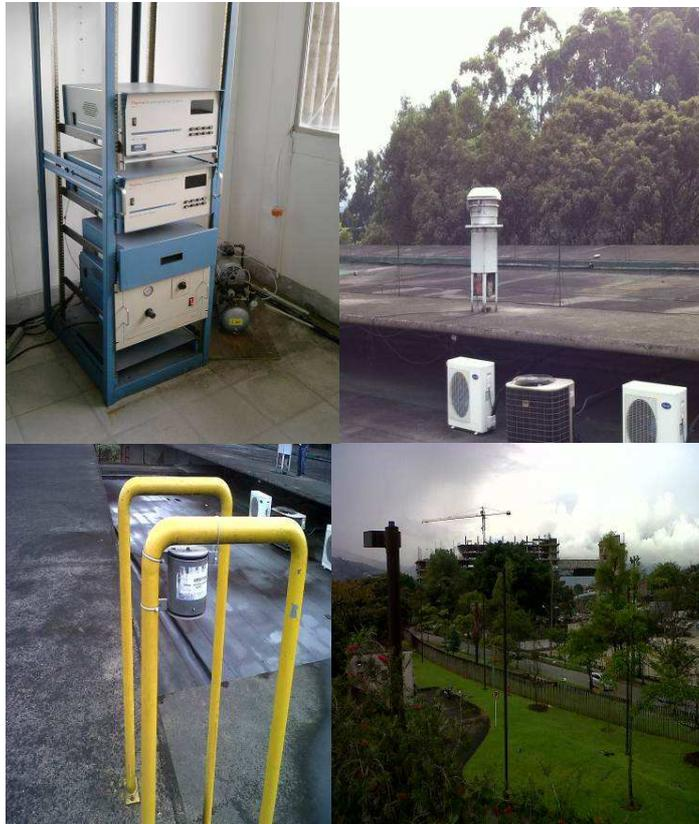
**Analizador de O<sub>3</sub>.** Viene trabajando correctamente. En el mes de abril de 2011 presento algunos datos negativos y estaba reportando los datos en un formato diferente. Se le realizó calibraciones de flujo y mejoró su funcionamiento. Se le ha realizado mantenimiento a la bomba, a la entrada de muestra y verificación de los parámetros. También se cambió la sílica gel y el carbón activado, esto con el fin de mejorar el sistema de calibración del equipo.
