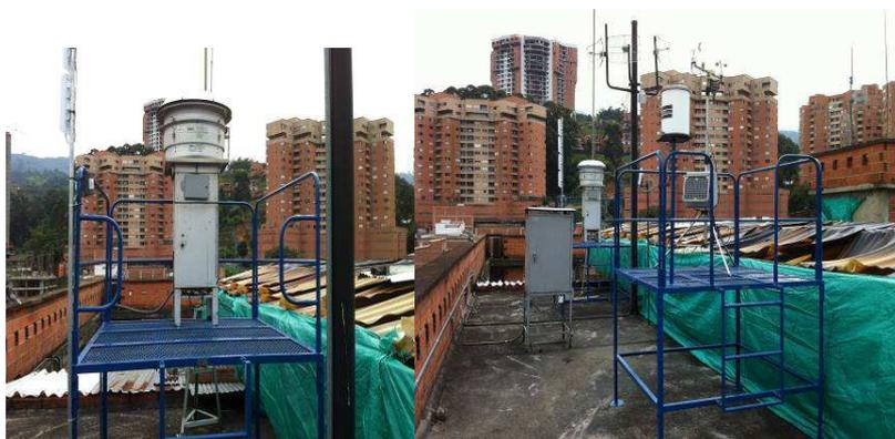
**PM<sub>10</sub> manual.** Se le cambia motor en el mes de mayo debido a desgaste propio por funcionamiento. Se le realiza mantenimiento general semanalmente al timer, nanómetros y controlador, además que se ha limpiado semanalmente el cabezote y rack exterior.
