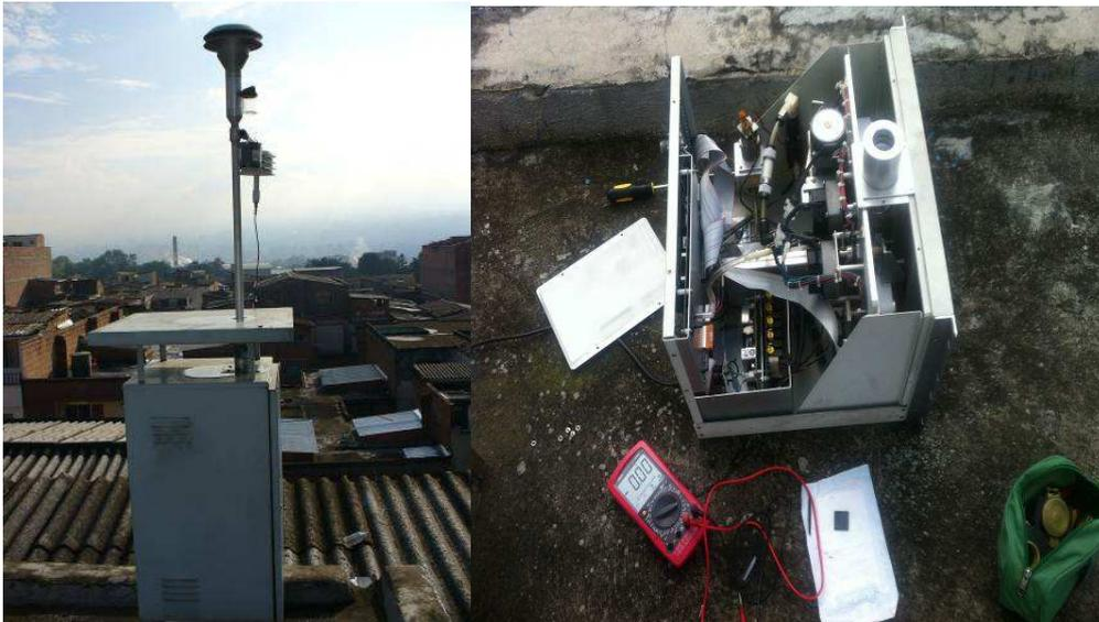
**PST manual:** El equipo viene trabajando correctamente. Presento problemas con el controlador de flujo y fue reparado. También se cambió motor por desgaste. Se le realizó limpieza general a toda la parte externa del equipo, mantenimiento al cabezote o a la entrada de muestra, al timer y manómetro.
