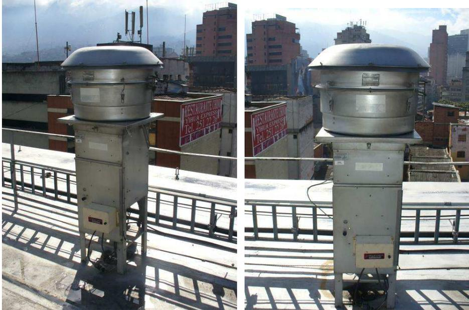
**Muestreador pasivo BTX.** Se comenzó en el mes de septiembre 2011 y se finalizó en mayo de 2012 con la toma de muestra y contramuestra para la determinación de la concentración de BTX (Benceno, Tolueno y Xileno) en la atmósfera, mediante la utilización de la técnica de monitoreo pasivo, donde cada 28 días se realiza el cambio de captadores passam.
