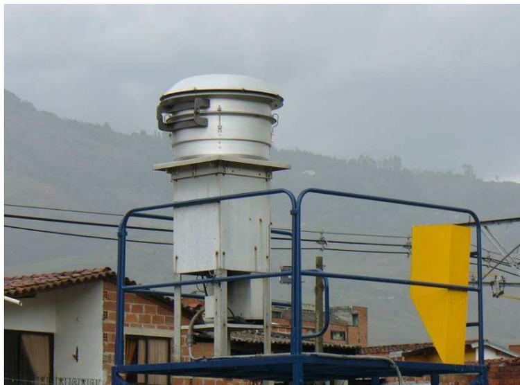
**Muestreador pasivo BTX.** Se comenzó en el mes de septiembre 2011 y se finalizó en mayo 2012 con la toma de muestra y contramuestra para la determinación de la concentración de BTX (Benceno, Tolueno y Xileno) en la atmósfera, mediante la
