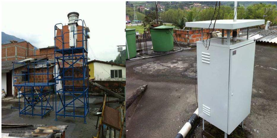
**PM<sub>10</sub> manual.** . El equipo funciona bien. Se le ha realizado mantenimiento general al cabezote, rack, motor y timer. Se perdieron algunos datos debido a que se cambio el motor por desgaste. Se realizan calibraciones de flujo cada vez que se cambia el motor o la escobillas.
