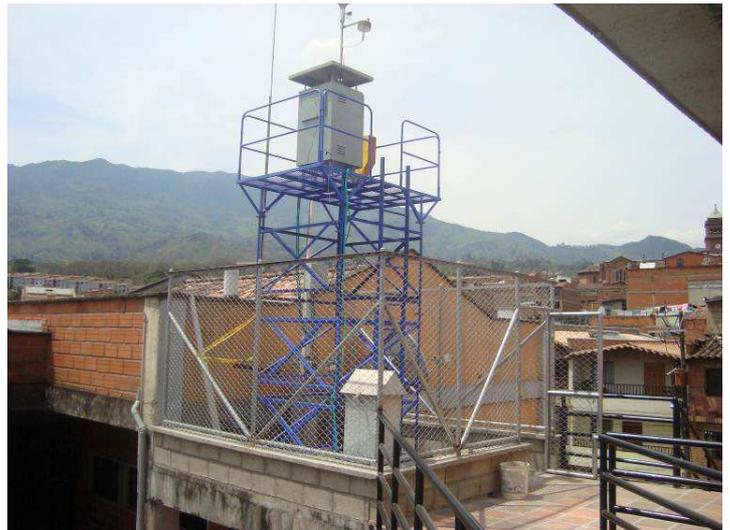
**PST manual.** Este equipo está a la espera de ser subido a un anexo que se le va hacer a la plataforma donde está el BAM1020. Se realiza periódicamente mantenimiento general, limpieza de timer y estructura física. Semanalmente se revisa buen funcionamiento del motor y las condiciones de operación del equipo para validación general de los datos. El equipo hasta el día de hoy opera correctamente, con algunas caídas de energía, por obras que se realizan en el colegio.
