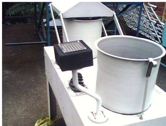
**Muestreador pasivo BTX.** Se comenzó en el mes de septiembre de 2011 y se finalizó en mayo de 2012 con la toma de muestra y contramuestra para la determinación de la concentración de BTX (Benceno, Tolueno y Xileno) en la atmósfera, mediante la
