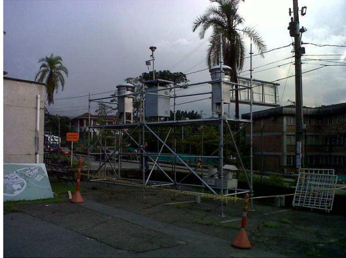
**PM<sub>10</sub> manual.** A partir del mes de Octubre 2011 se inició con muestreos diarios, excepto los domingos, utilizando dos equipos PM<sub>10</sub> manuales, seriales 14268 y 14262, a los cuales se les realiza periódicamente mantenimiento general, limpieza de la estructura física. Semanalmente se revisa buen funcionamiento del motor y las condiciones de operación de los equipos para validación general de los datos. Los equipos hasta el día de hoy operan correctamente.
