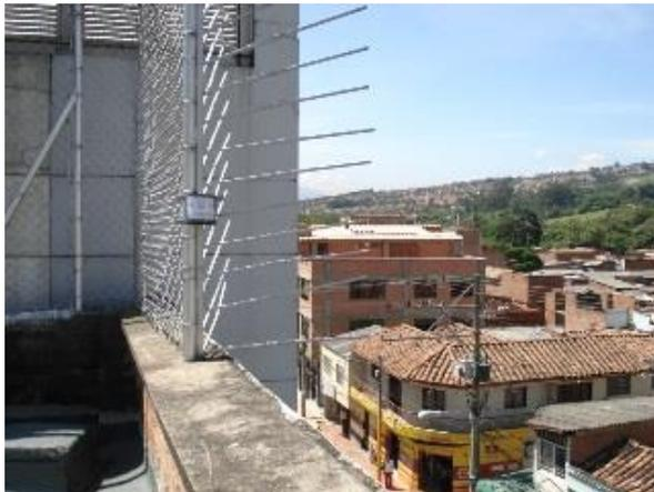
Muestreador pasivo de gases. Estación Bello.
