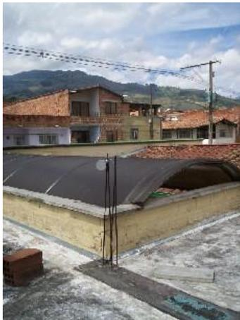
Tubos pasivos de difusión para la medición de gases en la estación Copacabana.
