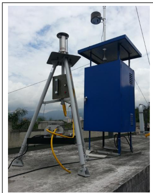
Figura 4.3. Impactor de Partículas GLEO operando simultáneamente con Estación PM2.5 Bloque 19-A Universidad nacional.
