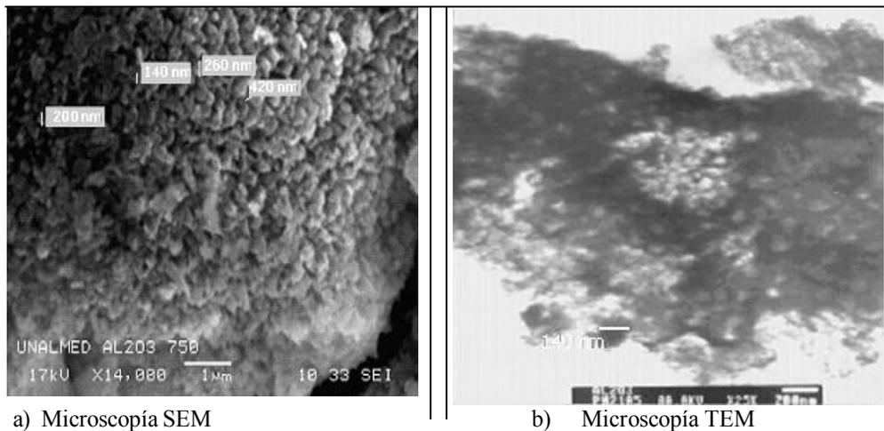
**Figura 7.** Alúmina sintetizada a pH 2.50 calcinada a 750°C.
