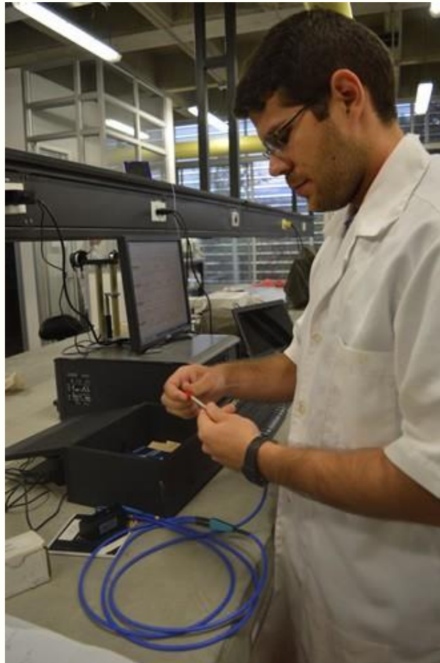
El espectrofotómetro UV/Vis (en la caja negra) es un equipo que mide la interacción de la luz con un cuerpo sólido y es capaz de detectar los cambios en las longitudes de onda.
