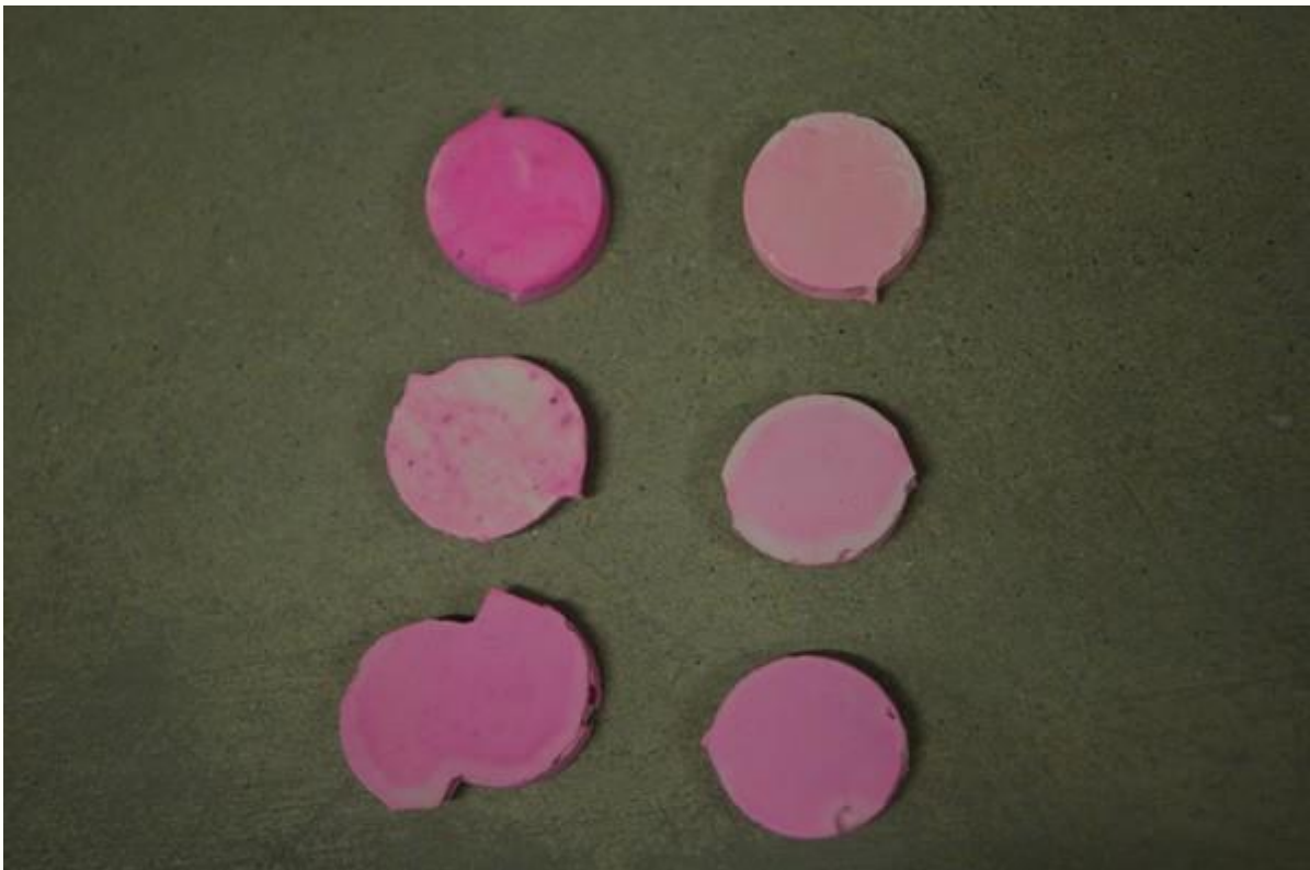
Las dos muestras superiores contienen adiciones de dióxido de titanio (3%), la de la izquierda fue expuesta a luz visible y la de la derecha a luz ultravioleta; se observa que el resultado con luz visible es prácticamente nulo. Las muestras del centro contienen dióxido de titanio modificado (3%), las nanopartículas que utiliza Juan David Cohen, igualmente la de la izquierda fue expuesta a luz visible y la de la derecha a luz ultravioleta. Las muestras de la parte inferior no contienen ninguna adición, son usadas como referencia.
