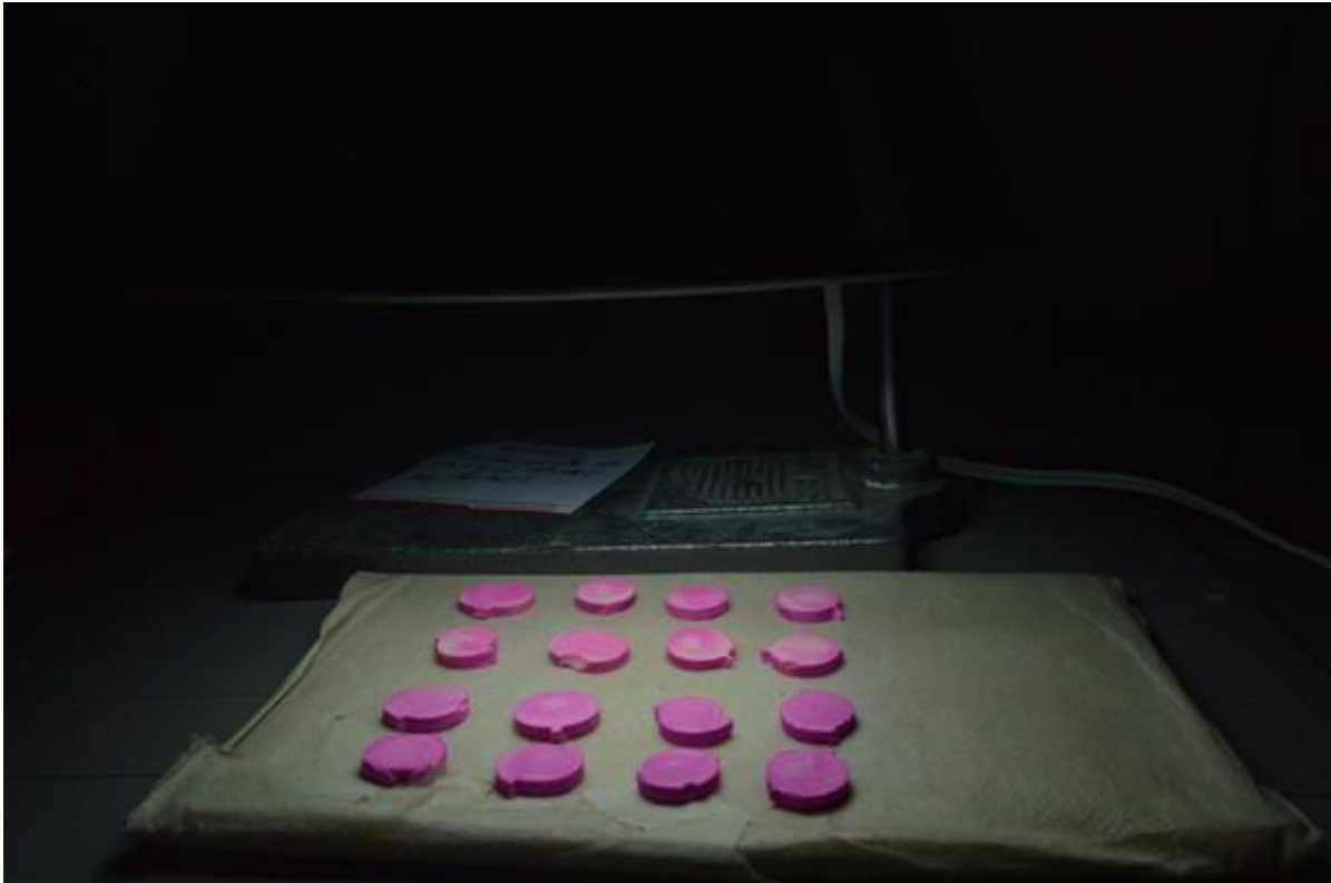
Resultados tras 5 horas de exposición a luz artificial, con 5% de adición de nanopartículas de dióxido de titanio modificadas. Las 8 muestras de la parte inferior no contienen adición, son usadas como referencia.
